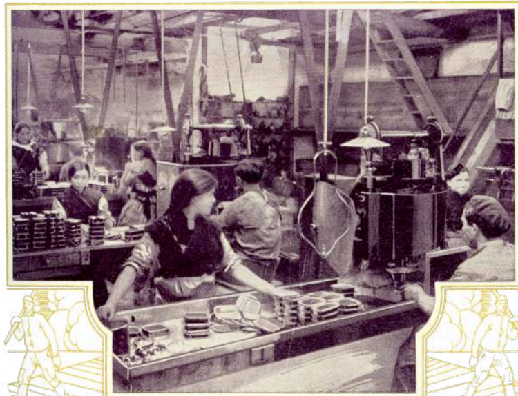
Pour fermer de grandes quantités de boîtes de Conserves, l'emploi de machines automatiques modernes, à grand rendement, est indispensable. Notre production atteint facilement 100.000 boîtes par jour de travail.
