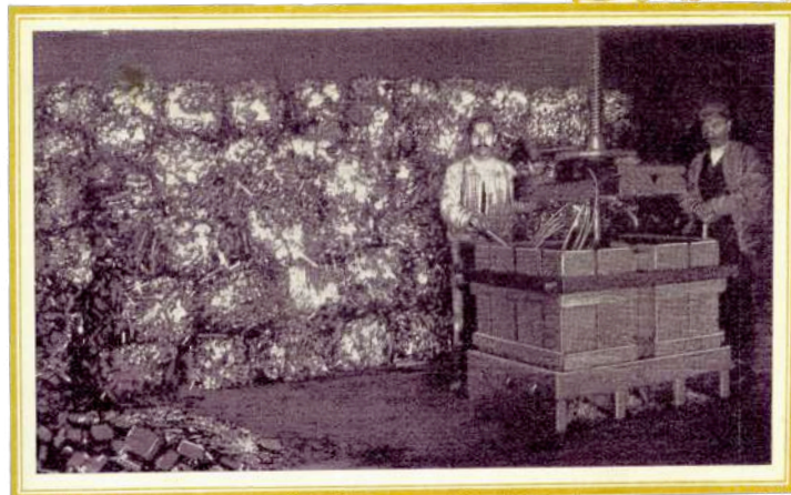
Le découpage des boîtes, dans des feuilles de fer-blanc amène un déchet inévitable. Ces déchets sont emballés pour l'exportation. Après triage, certains morceaux de fer-blanc sont employés à la fabrication des jouets.
