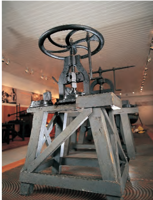
Prensa volante con tornillo sin-fin Talleres Sanjurjo. c.1890. Museo Massó, Bueu
