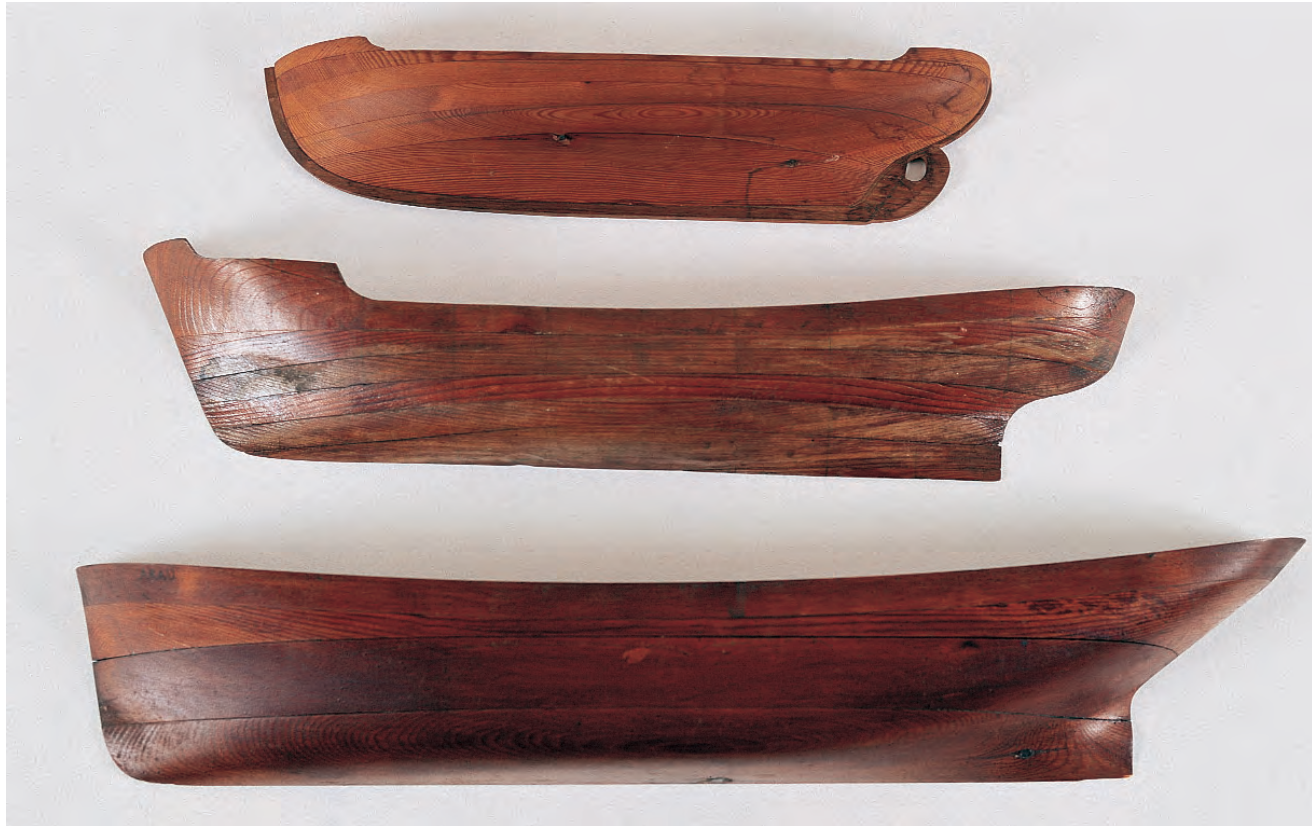
Modelos de medio casco utilizados en carpintería de ribera 1930-1950. Museo Massó, Bueu
